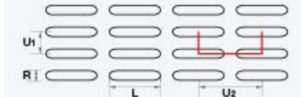
LR / U (oczka podłużne, układ prosty)
