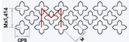
LC / U (oczka prostokątne, układ prosty)
