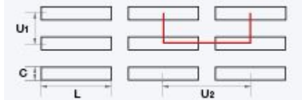
LR / UX (oczka podłużne, układ krzyżowy)
