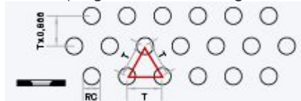
RI / T (Geprägtes Lochung, versetzt)
