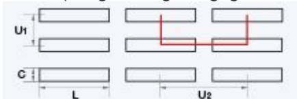
LR / UX (Langlochung, Schachbrettanordnung)
