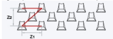
RC / T (Angesenkte Lochung, versetzt)
