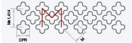
CPS / M (Sternlochung, diagonal versetzt)
