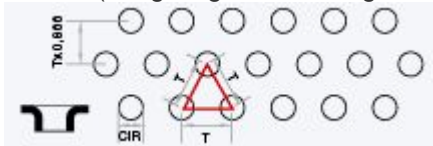
RI / M (Geprägtes Lochung, diagonal versetzt)
