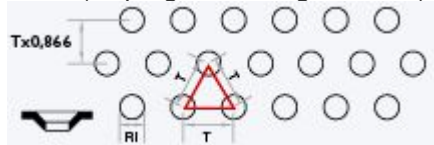
RI / Z (Geprägtes Lochung, versetzt)
