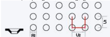
R / M (Rundlochung, diagonal versetzt)
