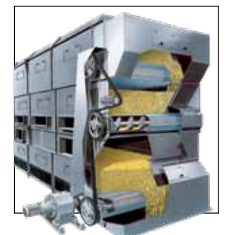
Conveyorsystem perforeret med aflange huller
