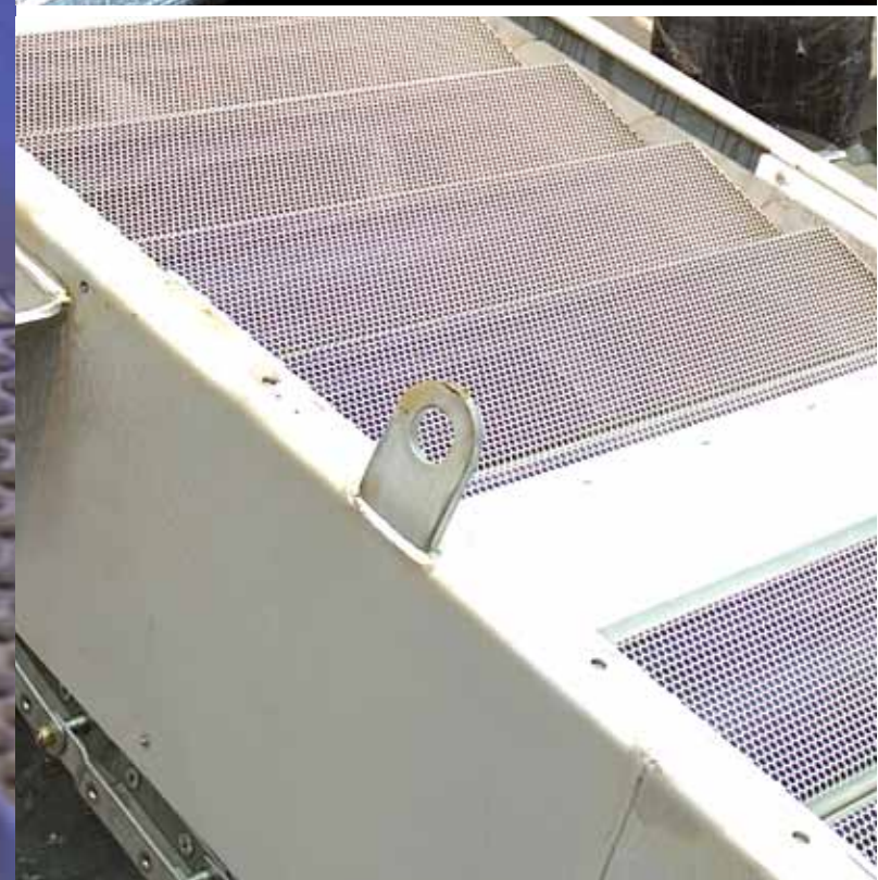
Indløb fremstillet i 3 mm tykt rustfrit stål EN 1.4301. RM mønster R6T8
